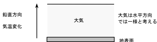
図 A5-1 平行平面大気近似：水平方向の大気は一様と考えると、鉛直方向だけの変化を考えればよい。
